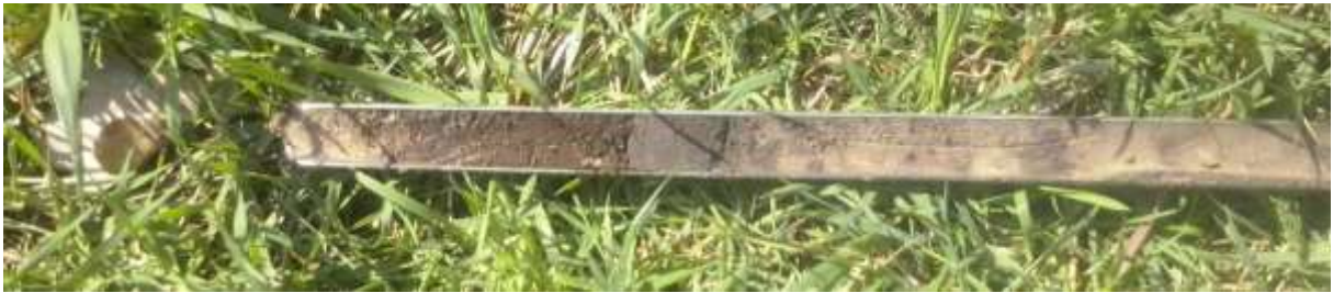
Figuur 19: Foto van de (onderkant van de) veenlaag die in boring 6 is aangetroffen.
