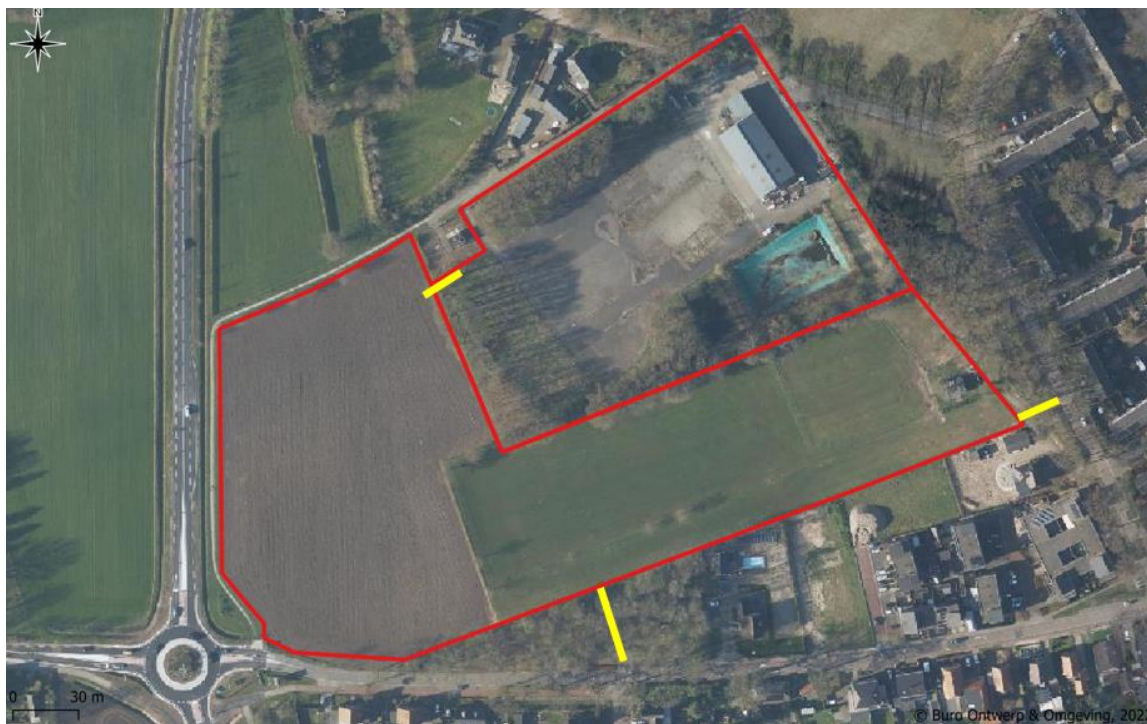
Figuur 1. Ligging van de gemeentewerf aan de Toonkweg en Kampweg (rood kader, noordoost) en het cluster aan de Hummeloseweg (rood kader, zuid en west). De gele lijnen tonen de toekomstige ontsluitingen/doorsteken door bestaande boomstructuren (bij benadering).
