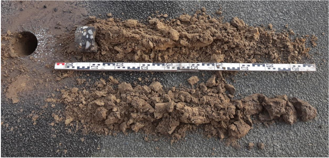
Afbeelding 14; Foto van het bodemprofiel van boring 2010 met v.l.n.r. en van boven naar onder de asfaltverharding en daaronder de sterk gevlekte subrecente ophoging met puin.
