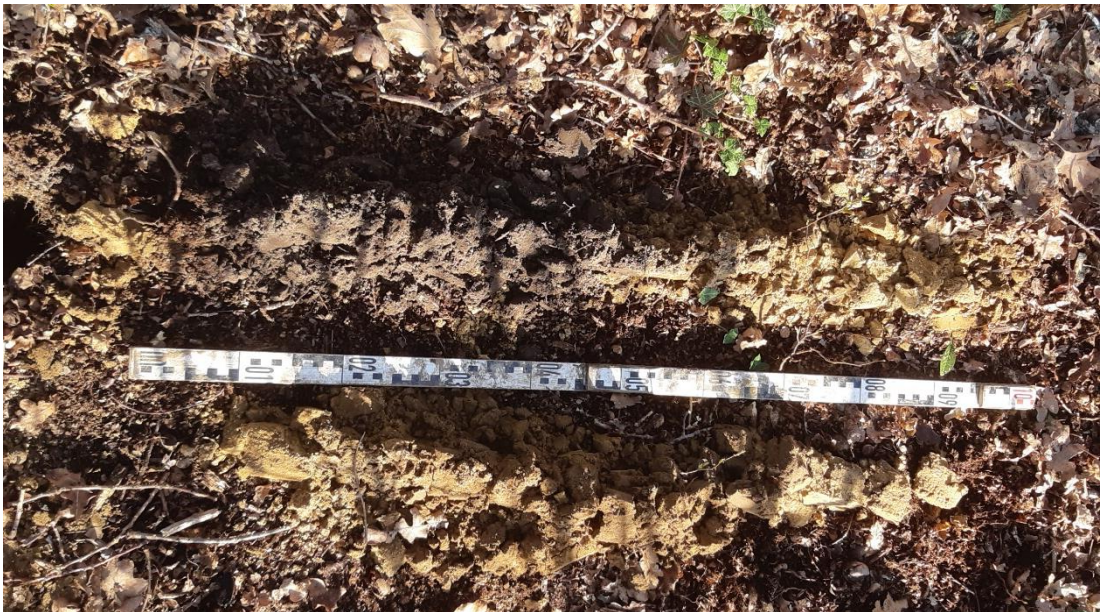
Afbeelding 15; Foto van het boorprofiel van boring 2011 met v.l.n.r. en van boven naar onder een laag bosstrooisel op een menglaag van geelgrijs gevlekt zand die overgaat in een laag lichtgeel stuifzand met daaronder een begraven bodem (cultuurlaag van lichtbruin fijn zand en vanaf 170 cm-mv dekzand.
