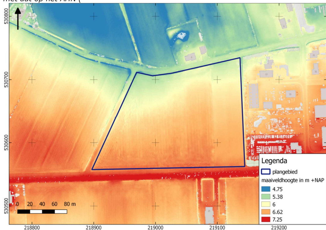
Afbeelding 4): van noord naar zuid is sprake van een geleidelijk oplopende welving, waarbij over een afstand van ongeveer 160 m een hoogteverschil van ruwweg 90 cm wordt overbrugd.
