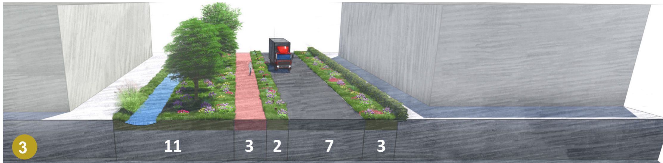
3 profiel hoofdas: 26 meter breed, incl. watergang en extra brede berm (eenzijde) met gestrooide bomenrij uit bestaande uit diverse boomtypen
