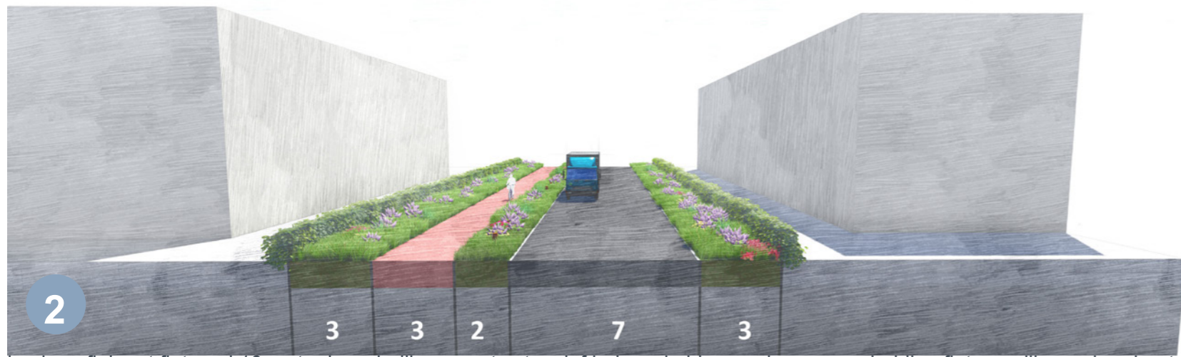
2 basisprofiel met fietspad 18 meter breed, rijbaan met extensief beheerde bloemenbermen, scheiding fiets en rijbaan door houten paaltjes
