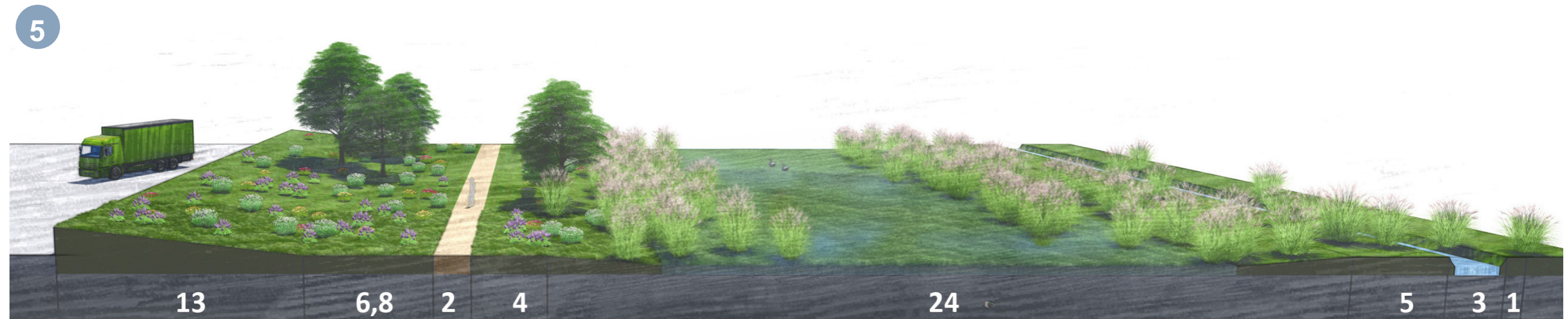
profiel noordelijke rand: wal met opgaande beplanting, halfverhard voetpad, verspreide kleine boomgroepen, extensief beheerde gras en waterbergingszone in de vorm van een wadi
