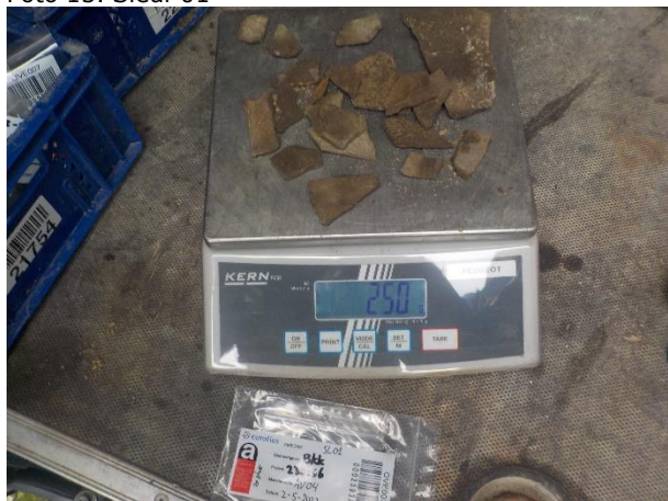
Foto 15. Aangetroffen asbest AV04 (250g)
