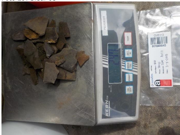
Foto 31. Aangetroffen asbest AV11 (247g)
