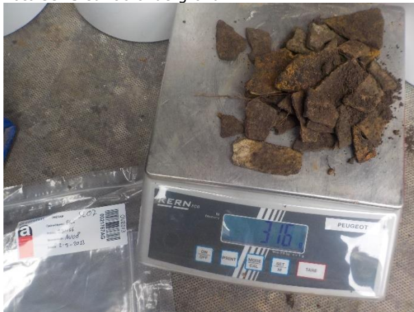
Foto 37. Aangetroffen asbest AV08 (316g)
