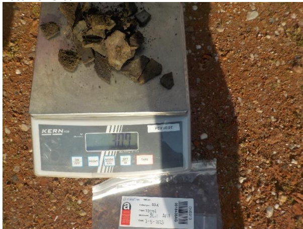
Foto 45. Aangetroffen asbest AV13 (307g)
