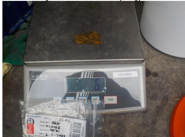
Foto 24. Aangetroffen asbest AV01 (6g)
