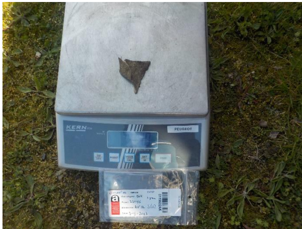
Foto 49. Aangetroffen asbest AV12 (10g)
