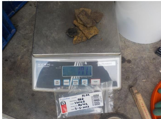
Foto 22. Aangetroffen asbest AV03 (171g)
