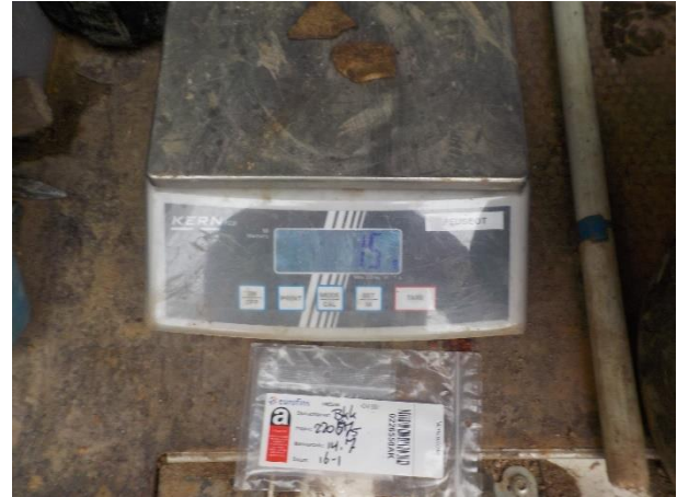
Foto 40. Asbestverdacht materiaal PG 14 (15gr)
