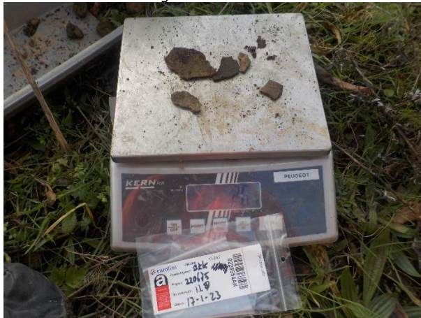
Foto 37. Asbestverdacht materiaal PG 11 soort 2 (26 gr)
