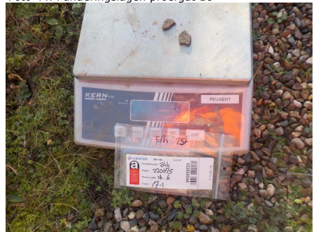
Foto 46. Asbestverdacht materiaal PG 16 soort 1 (4gr)
