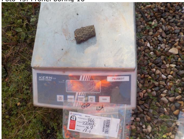
Foto 47. Asbestverdacht materiaal PG 16 soort 2 (18gr)
