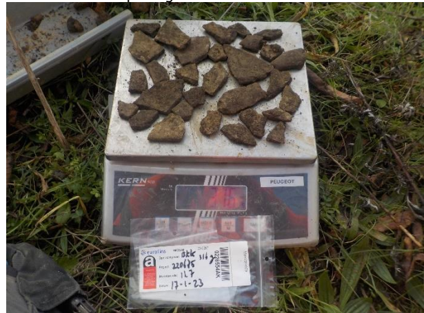
Foto 36. Asbestverdacht materiaal PG 11 soort 1 (316 gr)
