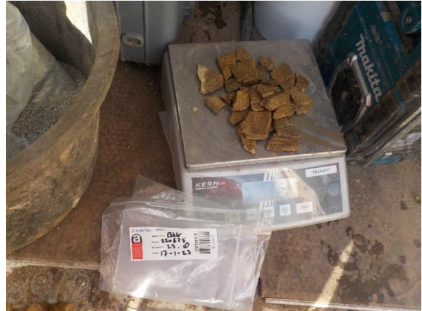
Foto 66. Asbestverdacht materiaal PG 23 soort 1 (353 gr)
