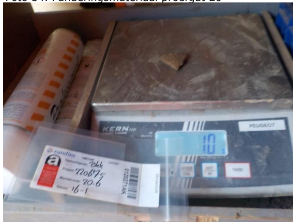
Foto 56. Asbestverdacht materiaal PG 20 soort 1 (10gr)
