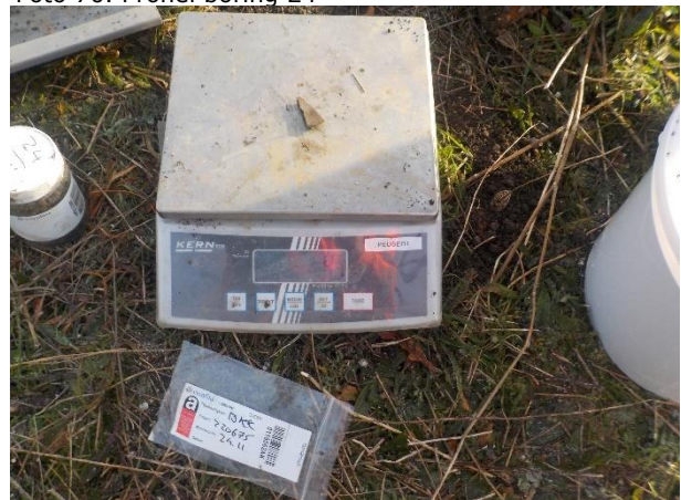
Foto 72. Asbestverdacht materiaal PG 24 soort 2 (4gr)
