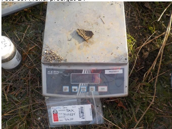
Foto 71. Asbestverdacht materiaal PG 24 soort 1 (6gr)
