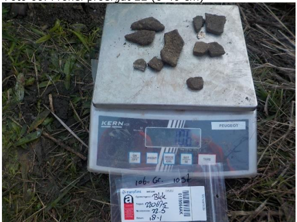
Foto 62. Asbestverdacht materiaal PG 22 soort 1 (106 gr)
