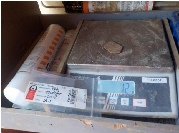
Foto 57. Asbestverdacht materiaal PG 20 soort 2 (12gr)
