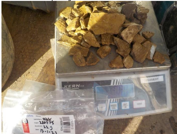
Foto 67. Asbestverdacht materiaal PG 23 soort 2 (700gr)
