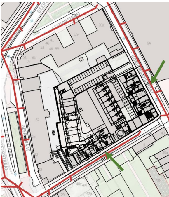
Figuur 5: Het plangebied met de omliggende gemengde gemeentelijke riolering. In groen de meest kansrijke locatie voor de aansluiting van de DWA van het plan (in zwart) op de gemengde gemeentelijke riolering.
