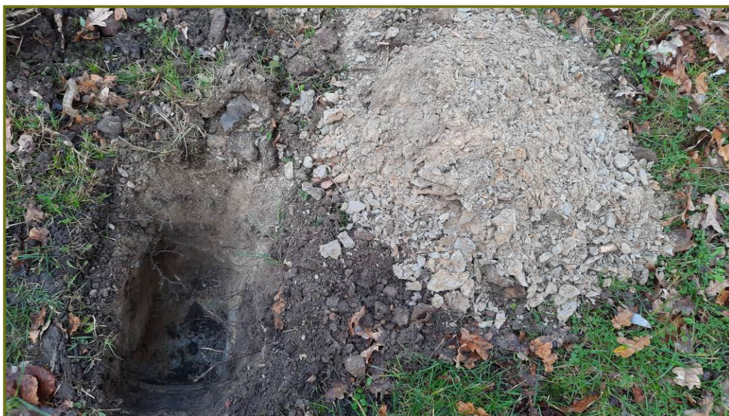
Afbeelding 25. Extreem verdichte laag wit lemig zand tot – 35 cm nabij de zomereik 228
