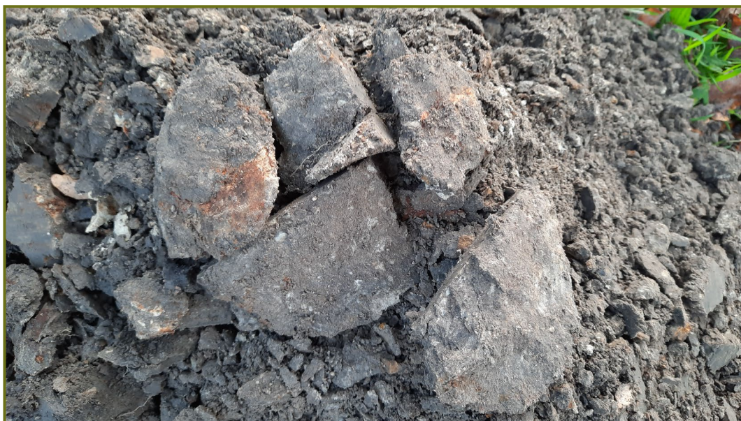
Afbeelding 31. Verdichte bodemstructuur direct naast het fietspad
