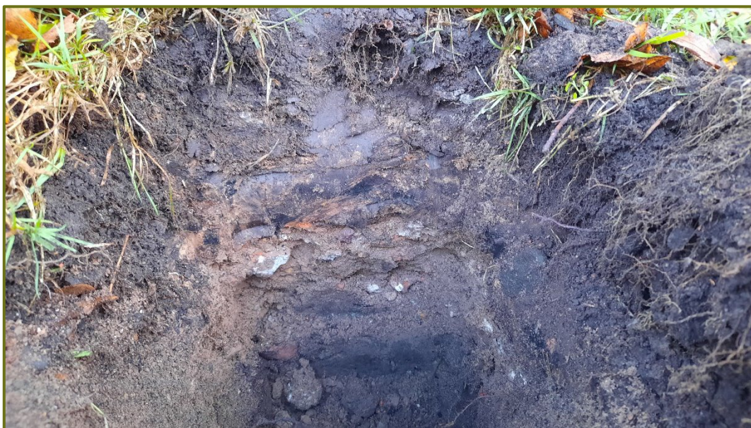
Afbeelding 23. Laag puin en geel zand tot -25 cm nabij de Hollandse linde 231
