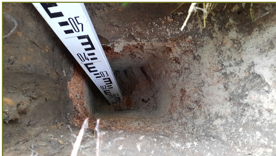
Afbeelding 45. Vrijwel geen wortels, wit zand en laagje puingrind
