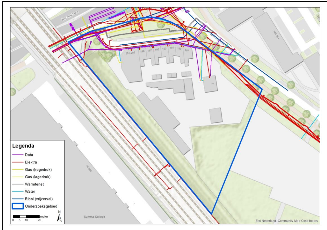
Afbeelding 17: overzicht ligging huidige kabels en leidingen
