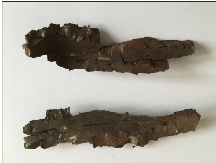
Afbeelding 35: Scherven na detonatie van een met springstof gevuld OO.
