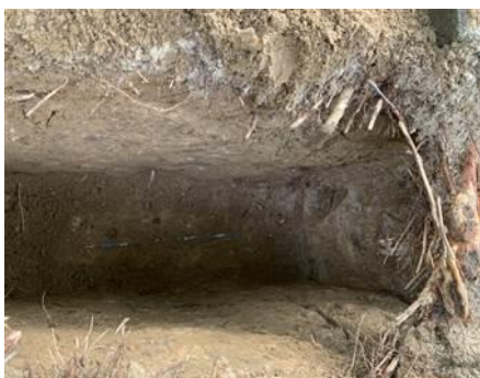
Afbeelding 9: beworteling en nutsvoorziening onderin profielkuil 2
