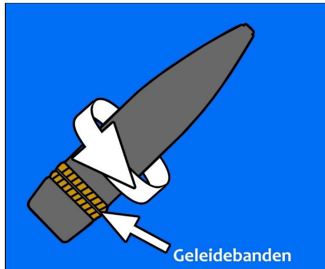
Figuur 41. Schematische weergave van het rotatieprincipe van een granaat. Bron: BeoBOM.
