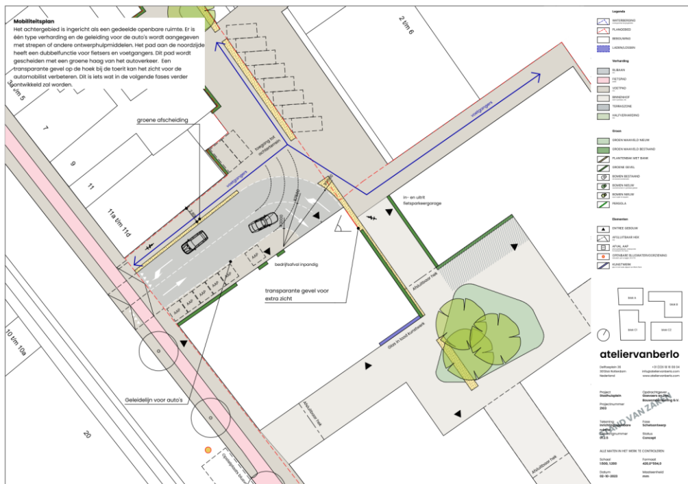
Afbeelding 7: In-/uitrit parkeergarage Citywall
