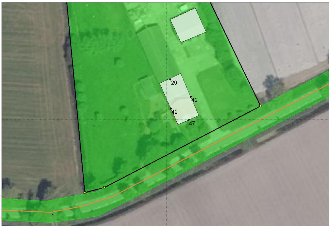
Figuur 4. Overzicht resultaten rekenmodel wegverkeer incl. aftrek 5 dB conform art 110g Wgh
