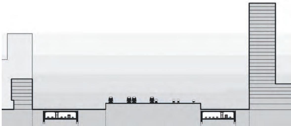
Afbeelding 2 Doorsnede van de infrastructuur Zuidasdok volgens het voorkeursalternatief (bron: planMER Zuidasdok 2012)
