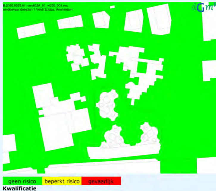
figuur 30: kwalificatie windgevaar deelplan 1: nieuwbouw rondom IJbaanpad
