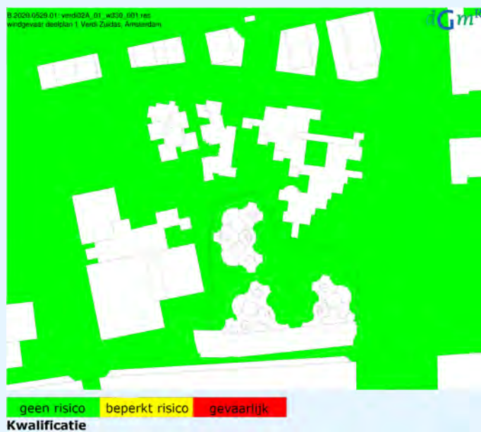
figuur 36: kwalificatie windgevaar na realisatie deelplan 1
