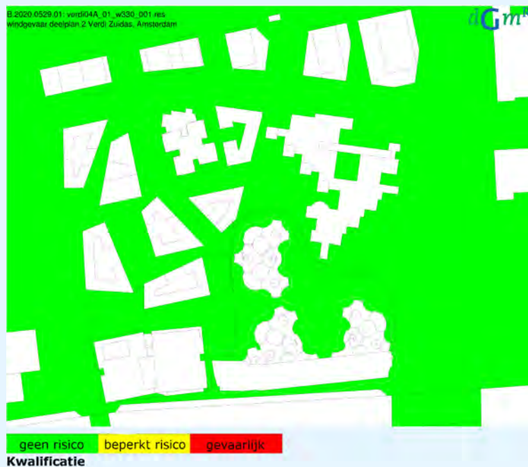
figuur 40: kwalificatie windgevaar deelplan 2 fase A en B.
