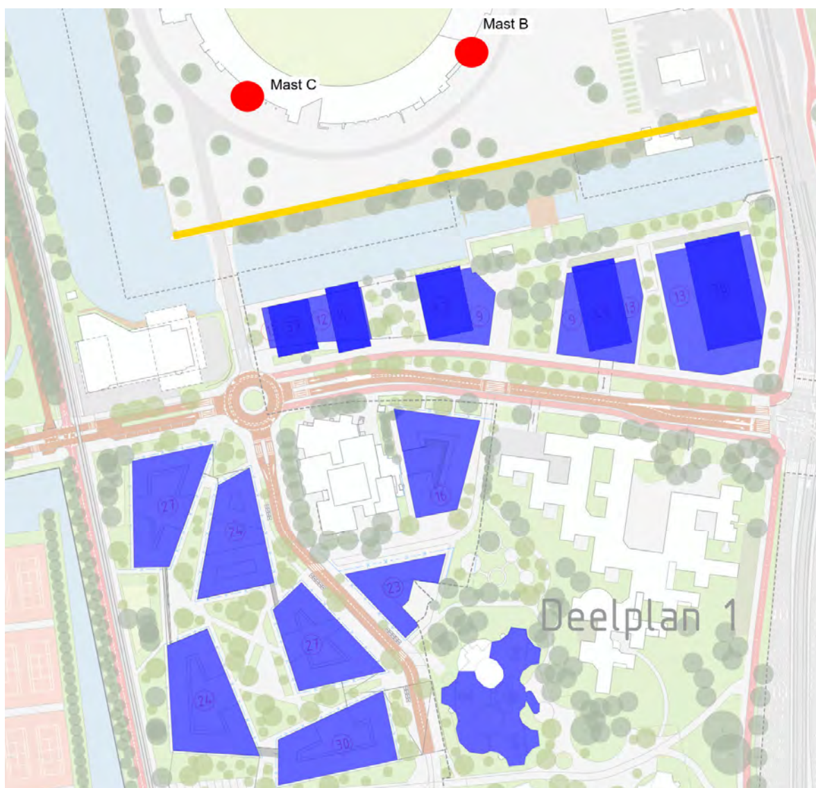
Figuur 4.3: Situatietekening met vereiste afscherming als overdrachtsmaatregel in oranje ingetekend. Het scherm heeft een lengte van ca. 270m en een minimale hoogte van 47,5m
