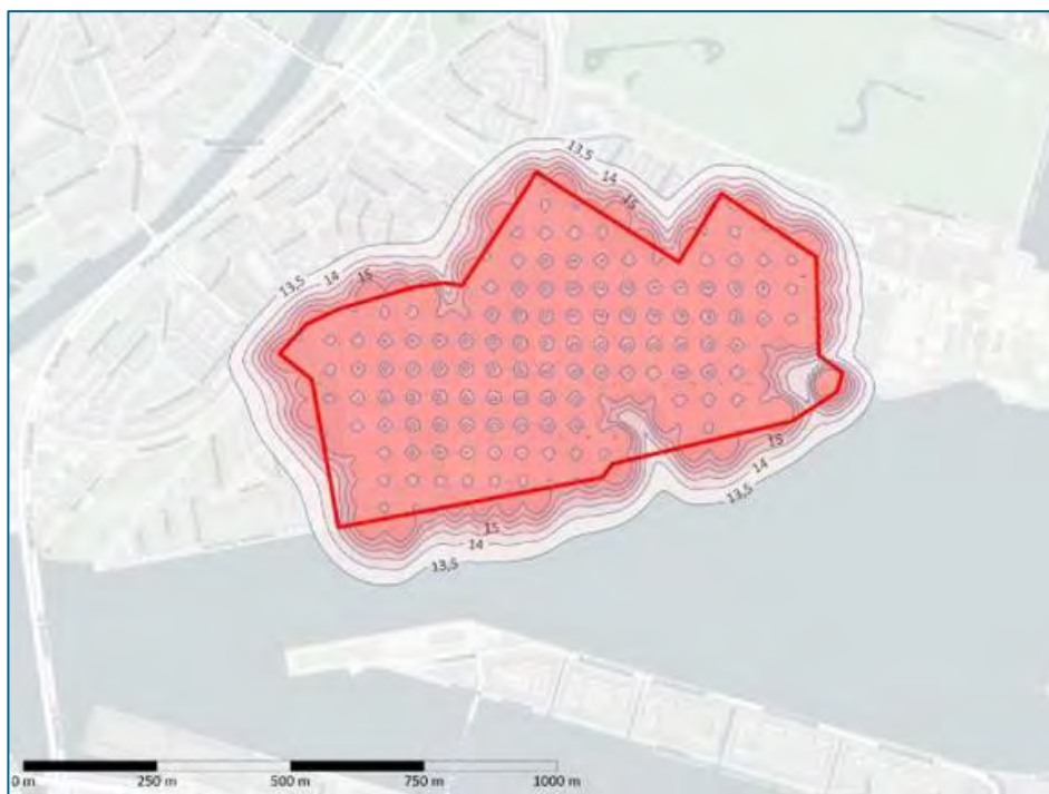
Figuur 5-72: Thermische effecten t.b.v. warme bronfilters (in graden Celsius).
