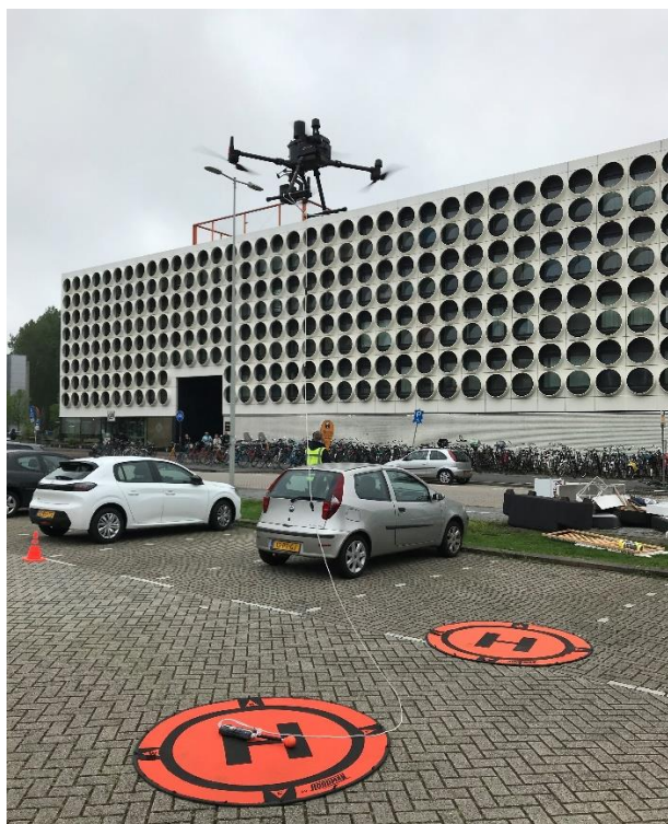
Figuur 4 Drone met meetinstrument tijdens de vlucht. Op de linkerfoto ligt het meetinstrument nog op de grond.
