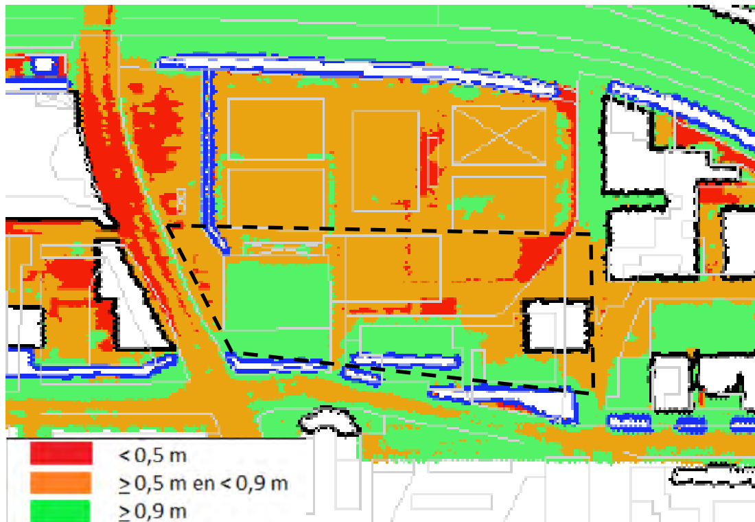
Figuur 5: Ontwatering bij de maatgevende hoge grondwaterstand (GHG) Ravel 2016, ondergrondse constructies (zwarte lijn) en watergangen (blauwe lijn) (GGZ, 2017) [2] met Ravel ontwikkelveld 2 in zwart gestreept kader.
