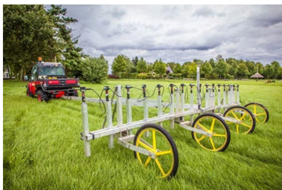
Figuur3. Passieve NON realtime oppervlakedetectie: Vallon Multisondesysteem VXV16 gemonteerd achter een voertuig.
