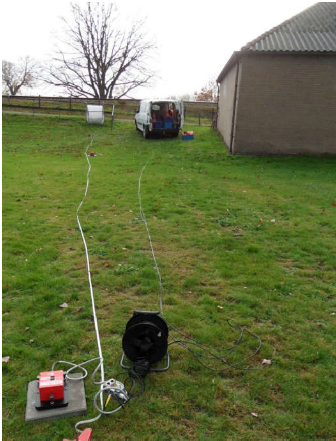
figuur 3 opstelling meetapparatuur langs spoor (drie afstanden)
