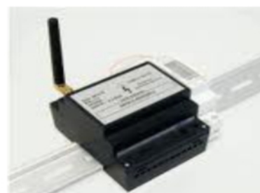
Foto: voorbeeld datalogger met puls-ingangen.
