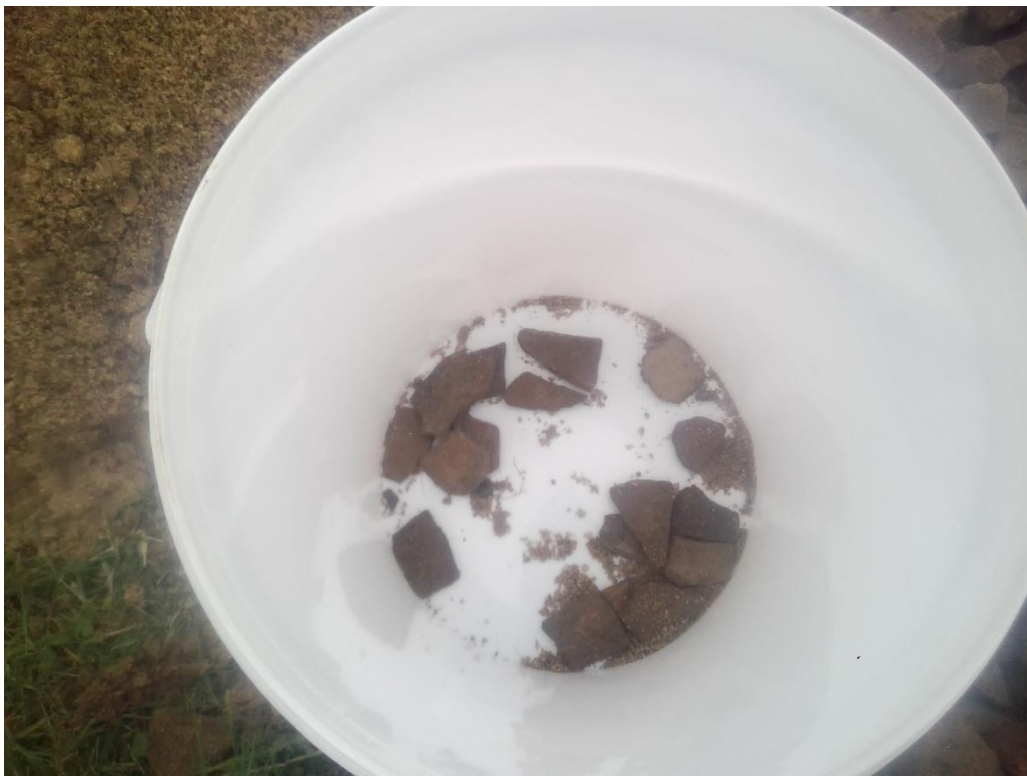
Foto 9. Asbestverdacht (plaat)-materiaal sleuf S1-04
