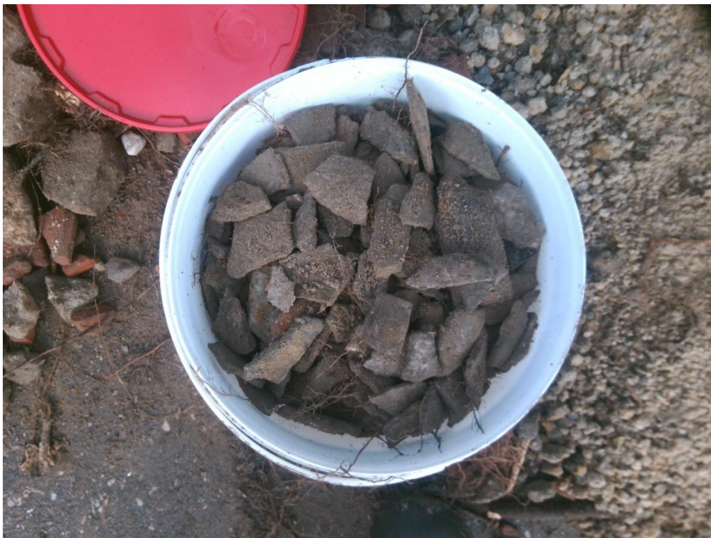
Foto 31. Asbestverdacht (plaat)-materiaal sleuf S3-03
