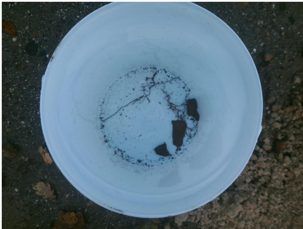
Foto 29. Asbestverdacht (plaat)-materiaal sleuf S3-02
