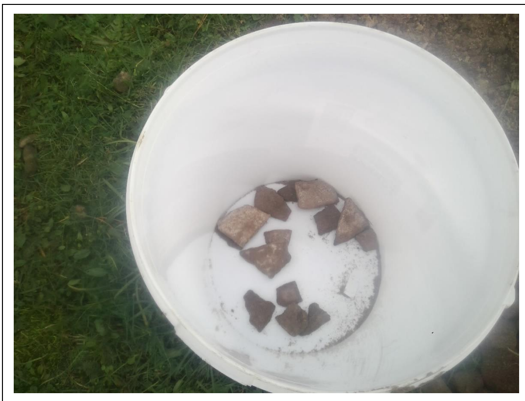
Foto 4. Asbestverdacht (plaat)-materiaal sleuf S1-02, traject 0,00-0,50 m -mv
