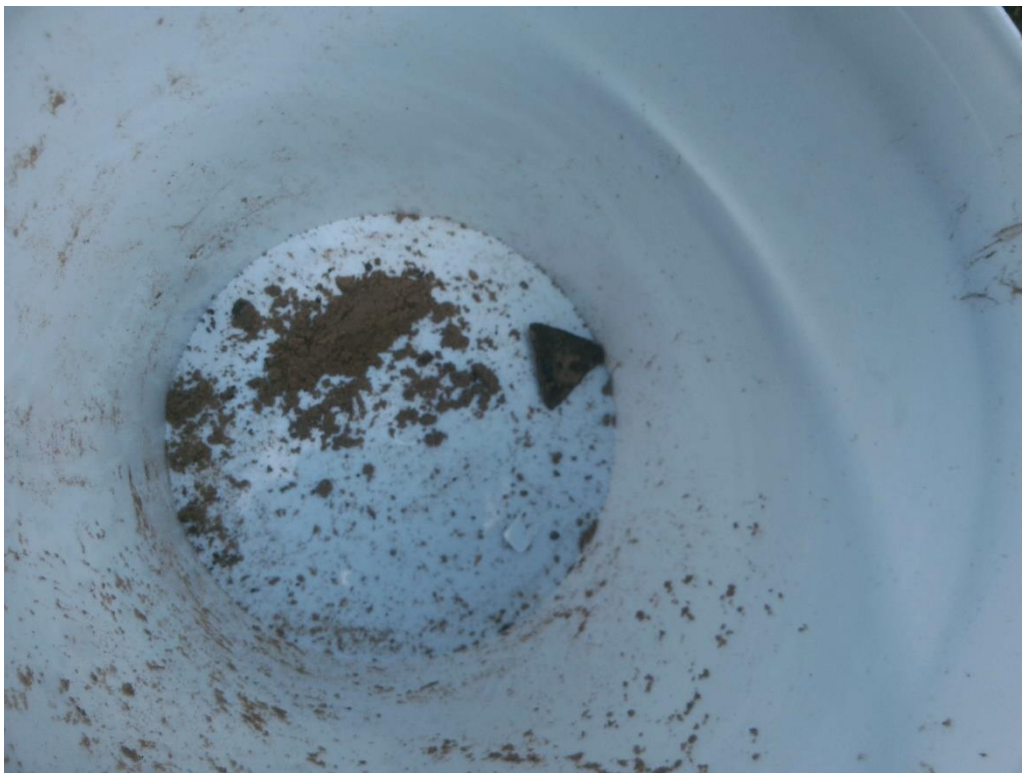
Foto 73. Asbestverdacht (plaat)-materiaal sleuf S4-21
