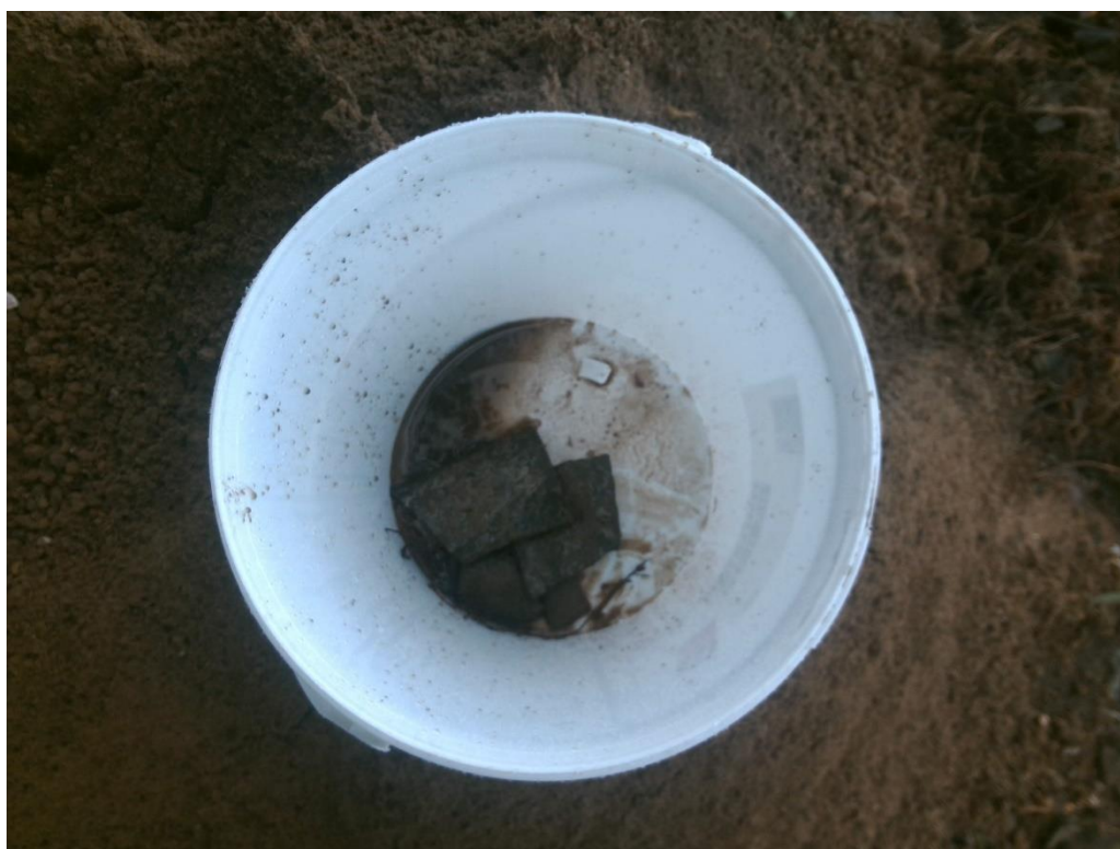
Foto 60. Asbestverdacht (plaat)-materiaal sleuf S4-14
