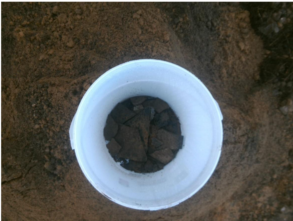
Foto 54. Asbestverdacht (plaat)-materiaal sleuf S4-10
