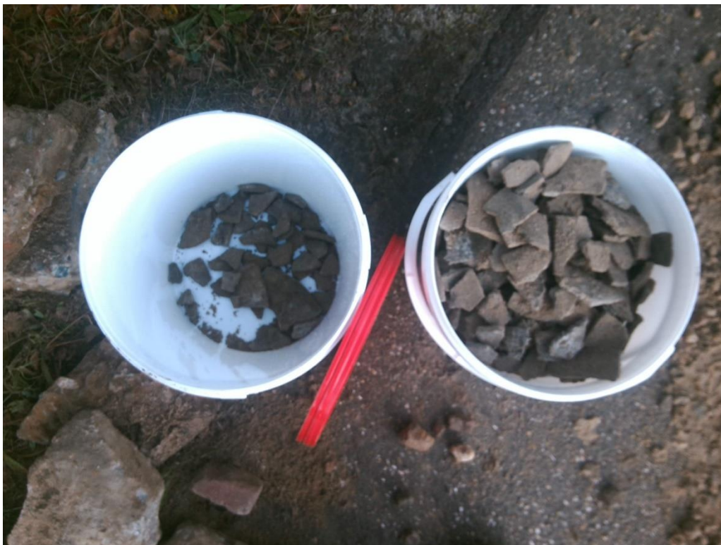
Foto 35. Asbestverdacht (plaat)-materiaal sleuf S3-05
