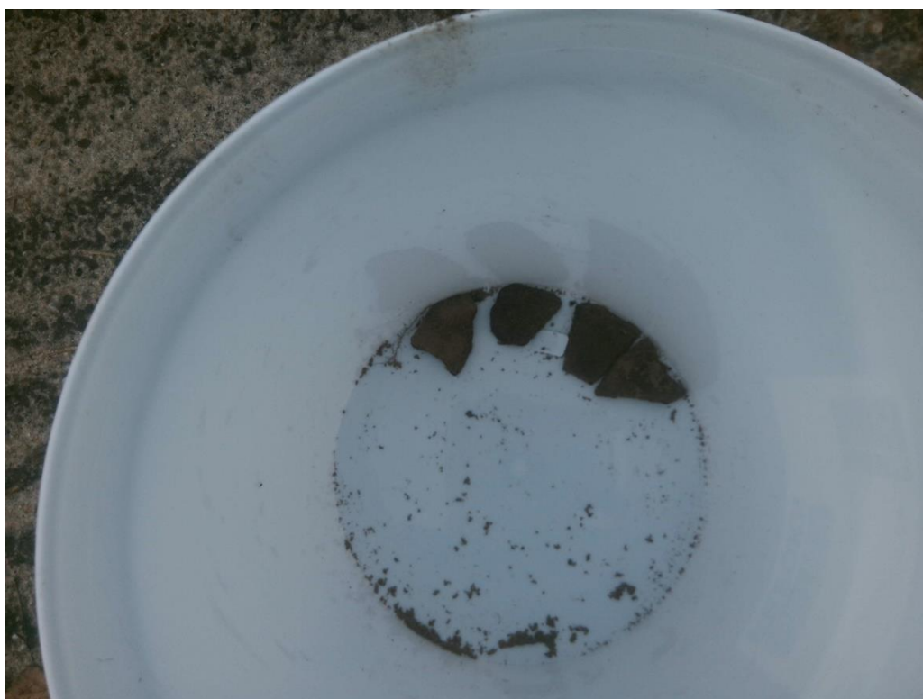
Foto 12. Asbestverdacht (plaat)-materiaal sleuf S2-01
