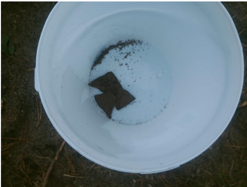
Foto 14. Asbestverdacht (plaat)-materiaal sleuf S2-03
