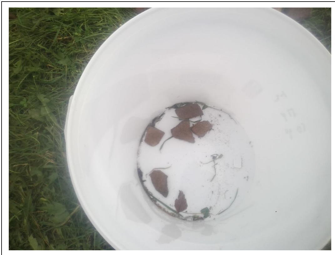
Foto 5. Asbestverdacht (plaat)-materiaal sleuf S1-02, traject 0,50-0,90 m -mv
