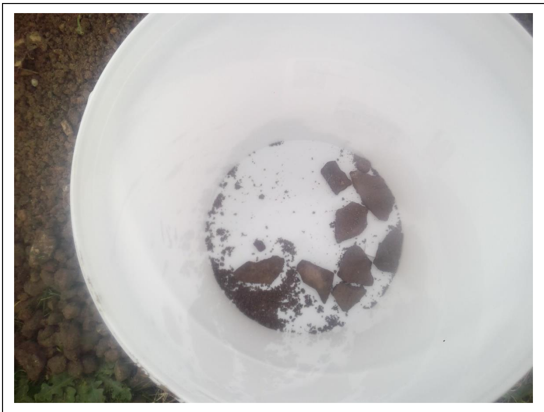
Foto 2. Asbestverdacht (plaat)-materiaal sleuf S1-01
