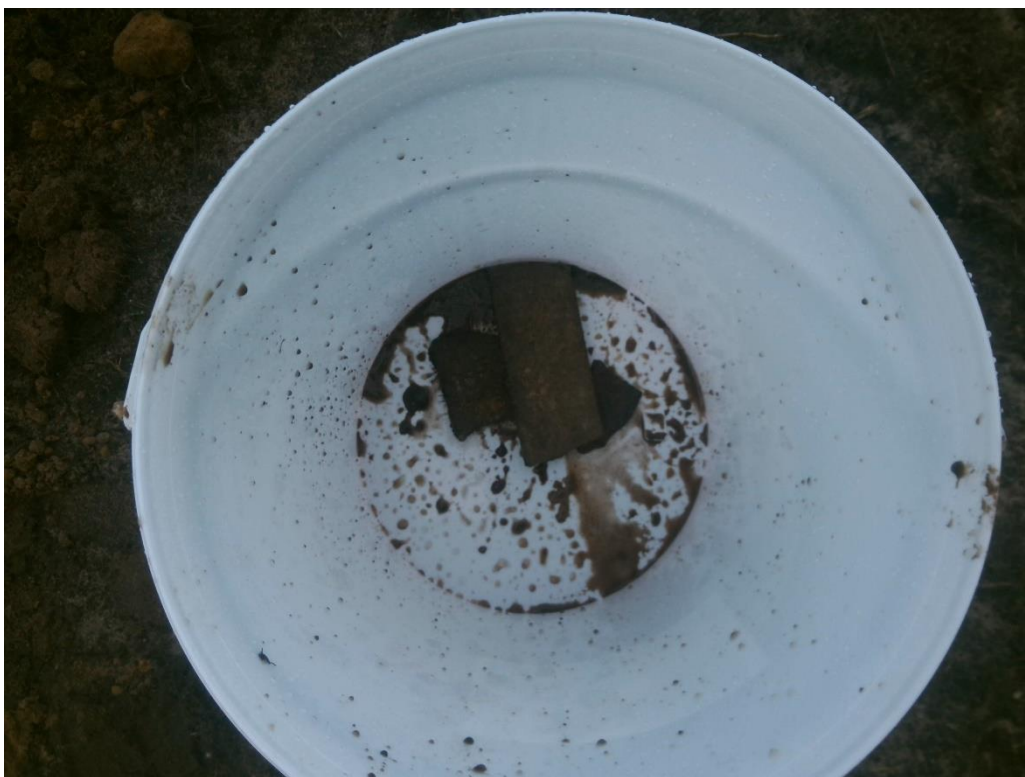
Foto 66. Asbestverdacht (plaat)-materiaal sleuf S4-17
