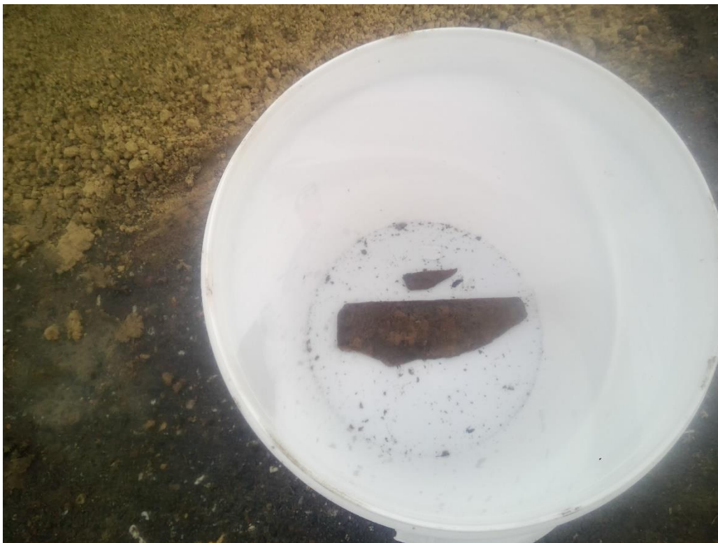
Foto 101. Asbestverdacht (plaat)-materiaal sleuf S5-03
