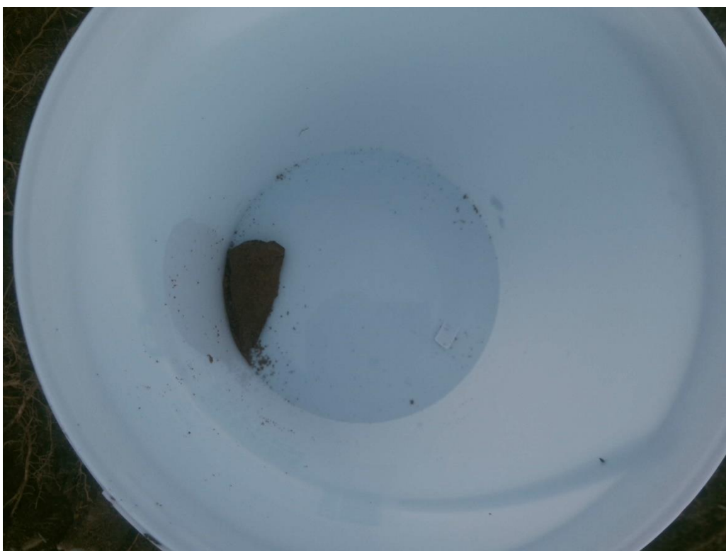
Foto 16. Asbestverdacht (plaat)-materiaal sleuf S2-04
