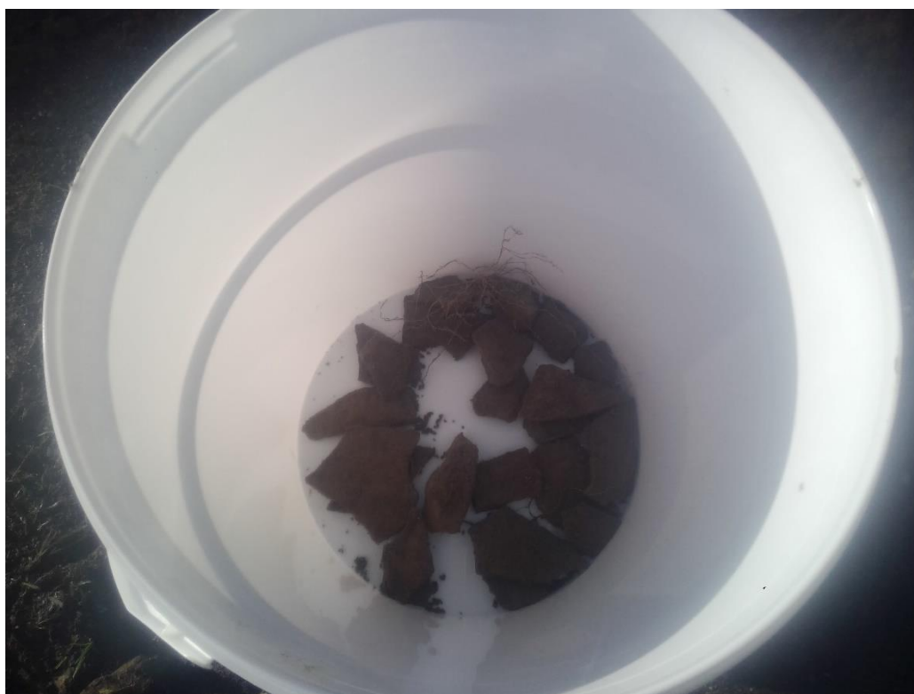
Foto 40. Asbestverdacht (plaat)-materiaal sleuf S3-07
