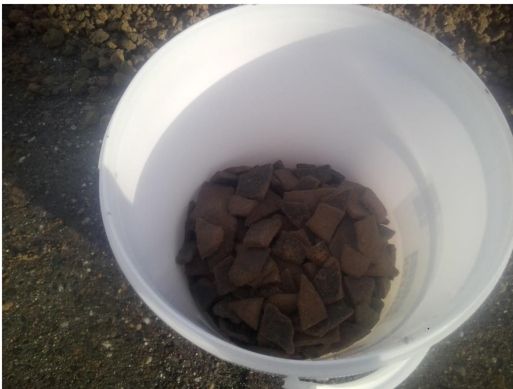
Foto 42. Asbestverdacht (plaat)-materiaal sleuf S3-08
