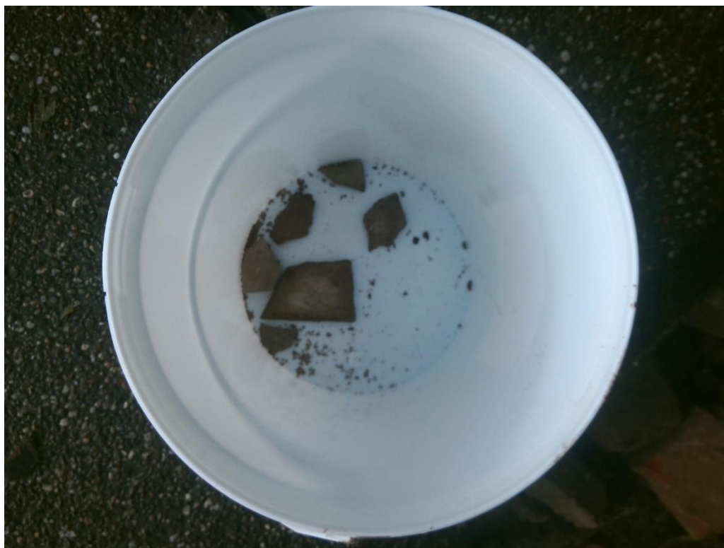
Foto 37. Asbestverdacht (plaat)-materiaal sleuf S3-06
