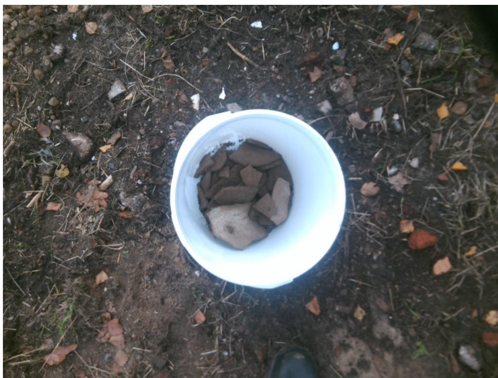
Foto 26. Asbestverdacht (plaat)-materiaal sleuf S2-10
