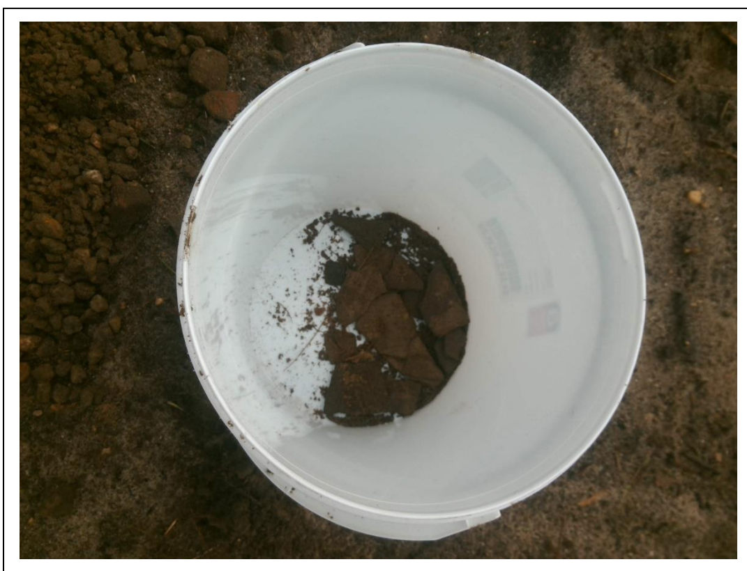
Foto 96. Asbestverdacht (plaat)-materiaal sleuf S4-34
