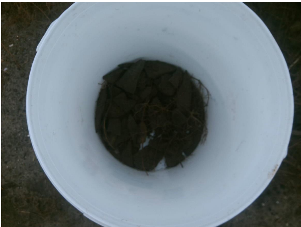
Foto 81. Asbestverdacht (plaat)-materiaal sleuf S4-26
