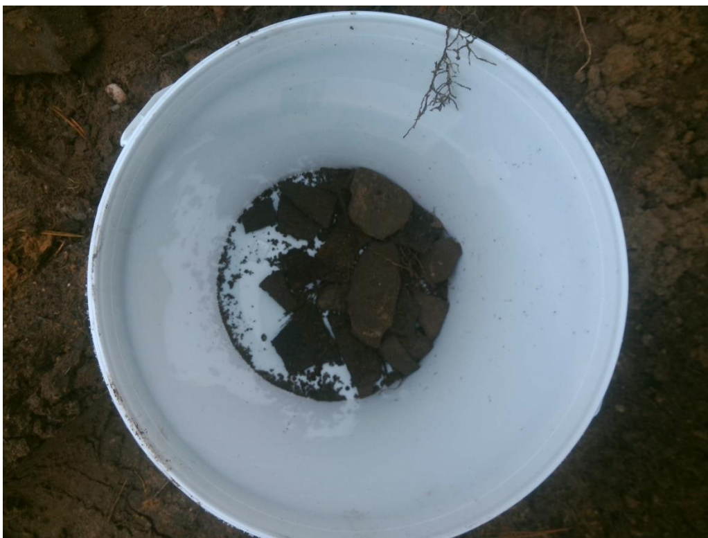
Foto 58. Asbestverdacht (plaat)-materiaal sleuf S4-12
