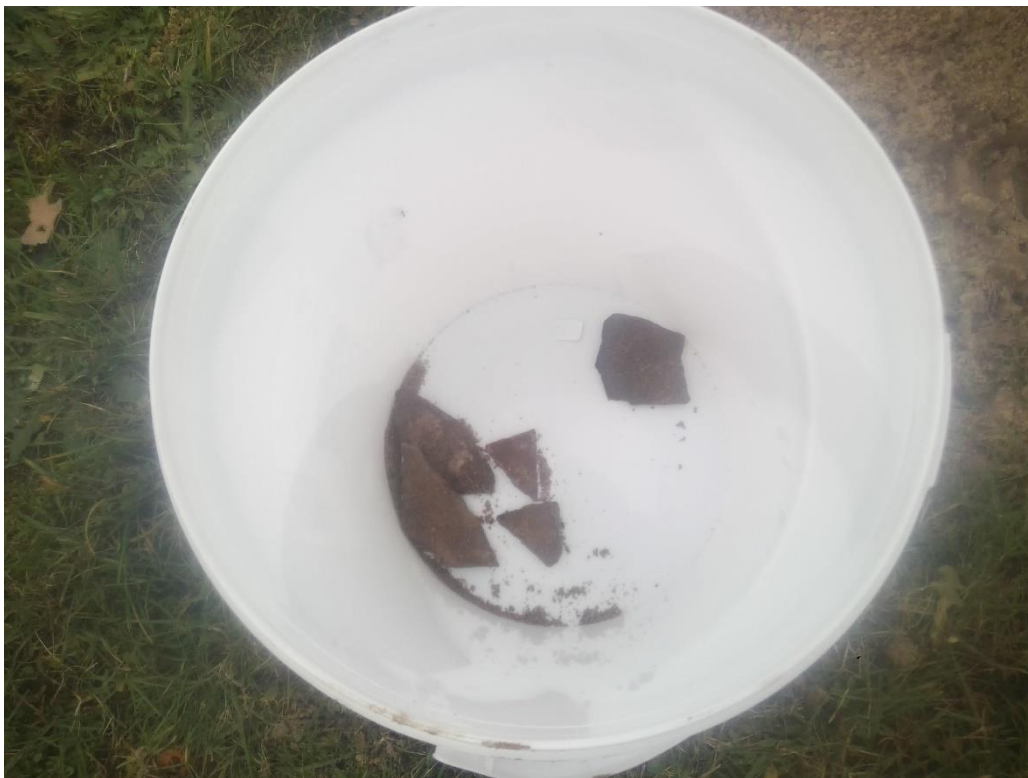
Foto 7. Asbestverdacht (plaat)-materiaal sleuf S1-03
