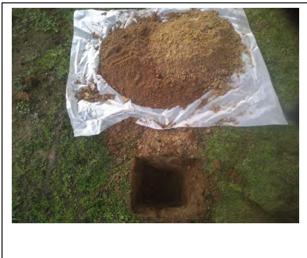
Foto: Inspectiegat B40
