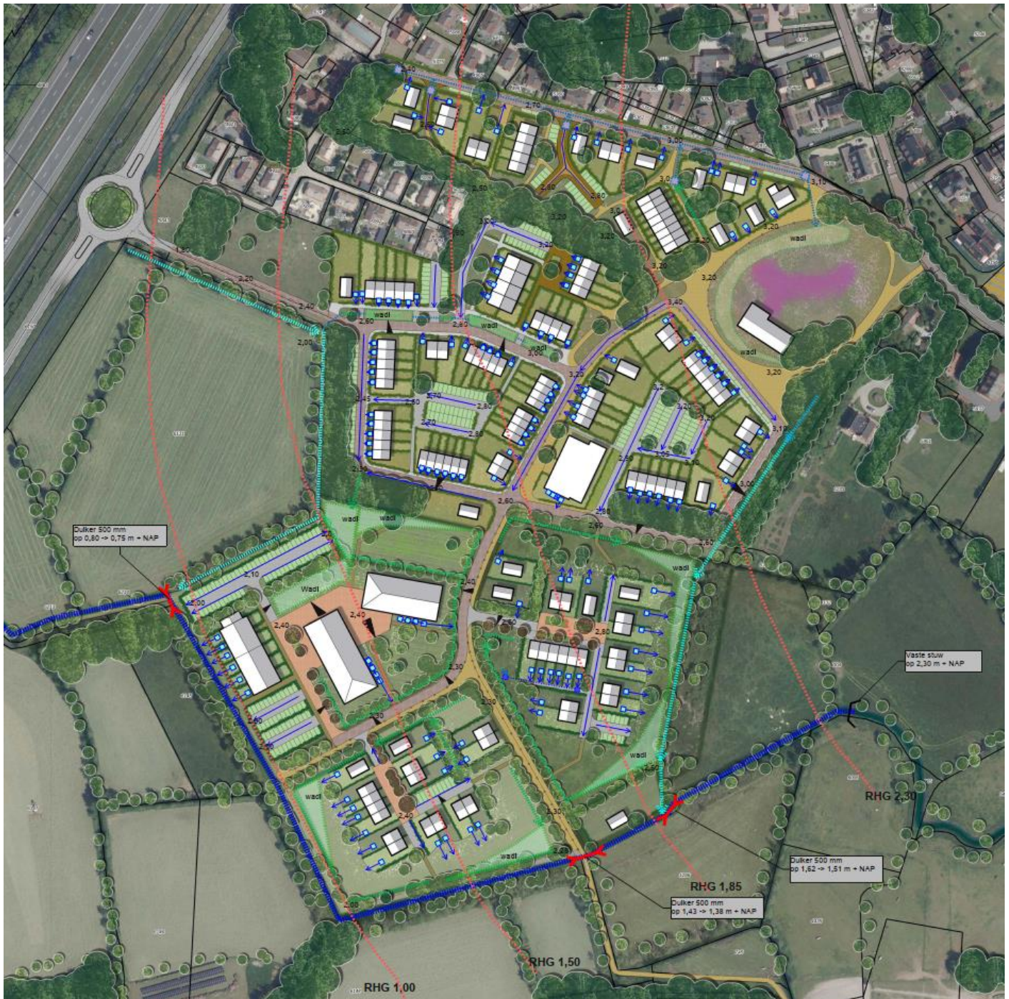
Figuur 12: Afwateringsprincipe plan Horsterhoeve (zie ook Bijlage C).
