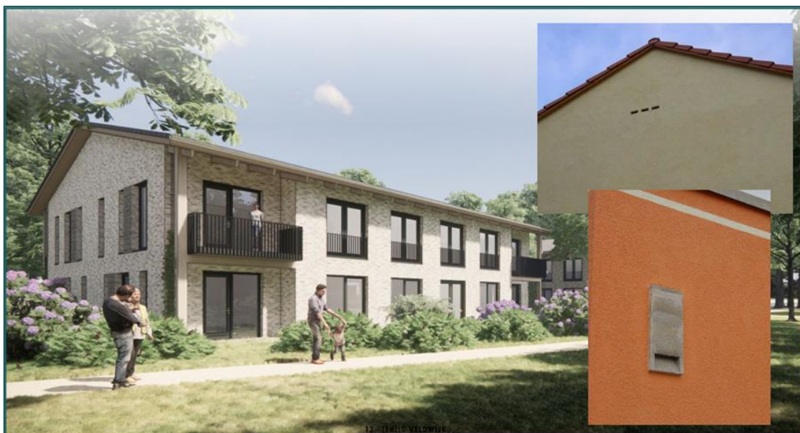
Figuur 16 Kopgevel appartementen complex Veldwijk en voorbeelden hoe de vleermuiskokers verwerkt kunnen worden in de gevel. Bron: Veldshop.nl
