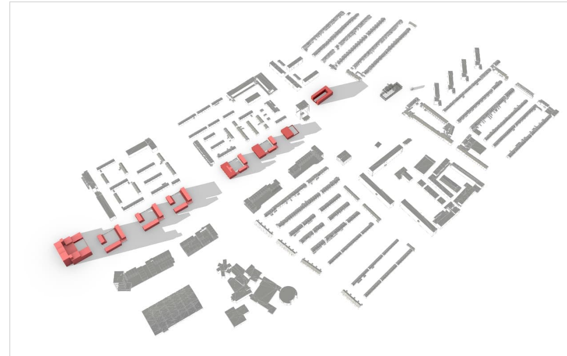
Figuur 10: slagschaduw fase 1 op 19 februari om 17:00 uur
