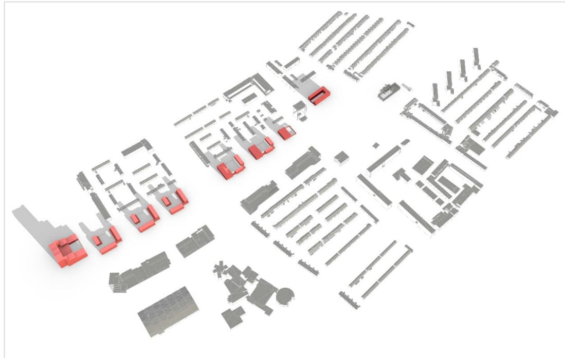
Figuur 9: slagschaduw fase 1 op 19 februari om 9:00 uur
