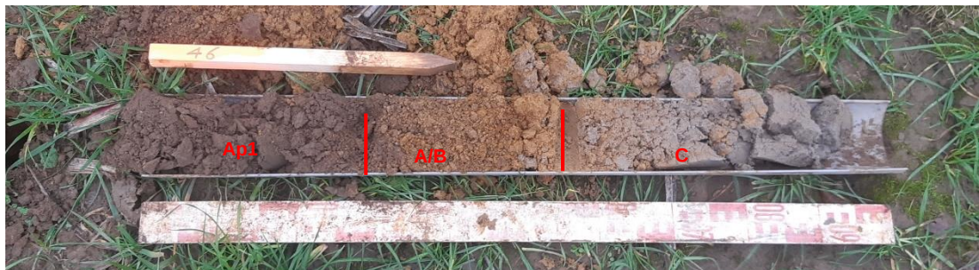
Afbeelding 15: Boring 46 met van links naar rechts de bouwvoor (Ap1), de menglaag (A/B) en het dekzand (C).
