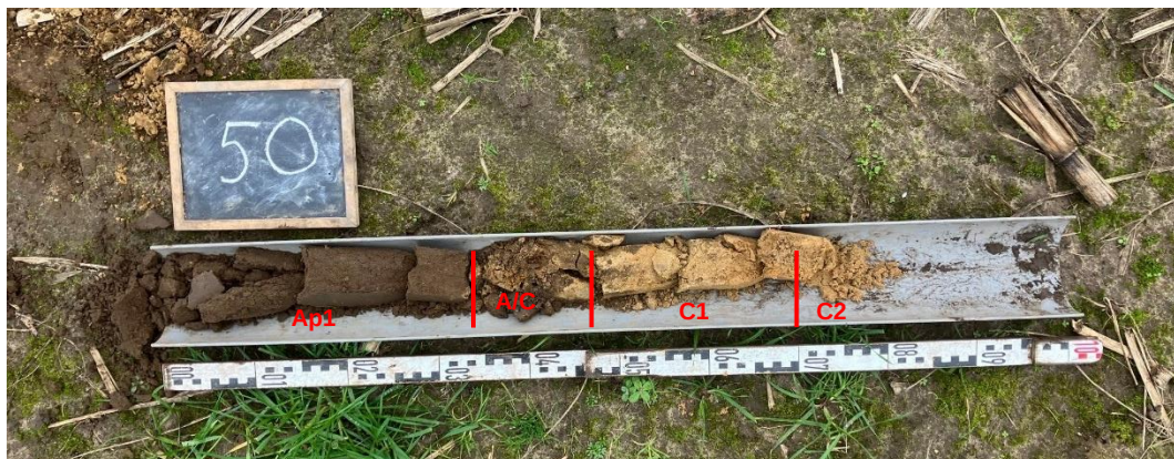
Afbeelding 16: Boring 50 met van links naar rechts de bouwvoor (Ap1), de menglaag (A/C) en het dekzand (C1-C2).
