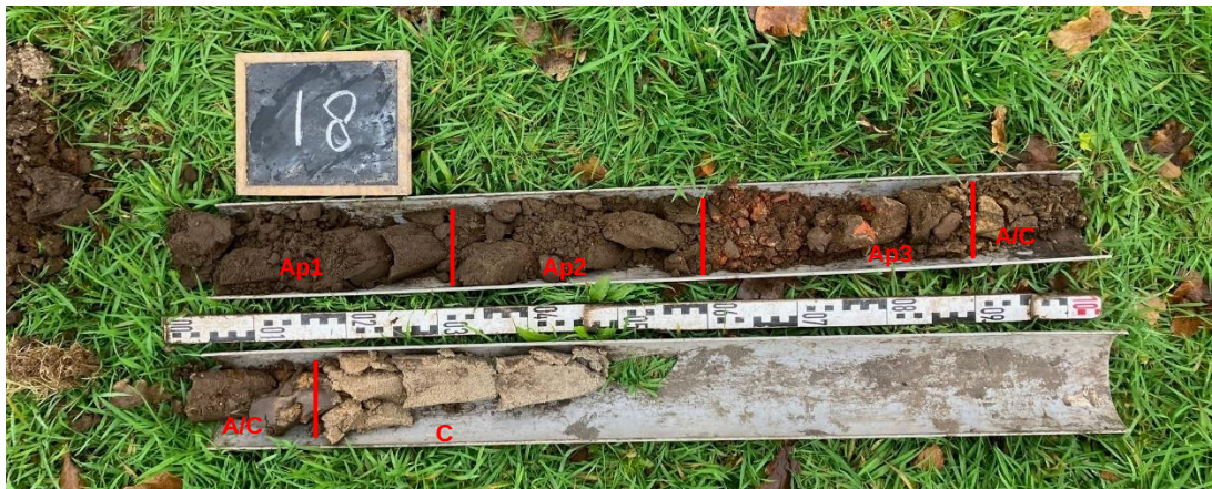
Afbeelding 13: boring 18 met van linksboven naar rechtsonder de bouwvoor (Ap1), de subrecent geroerde lagen (Ap2-Ap3), de menglaag (A/C) en het dekzand (C).
