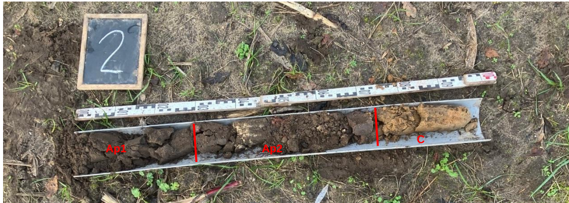
Afbeelding 11: boring 2 met van links naar rechts de bouwvoor (Ap1), de subrecent geroerde laag (Ap2) en het dekzand (C).
