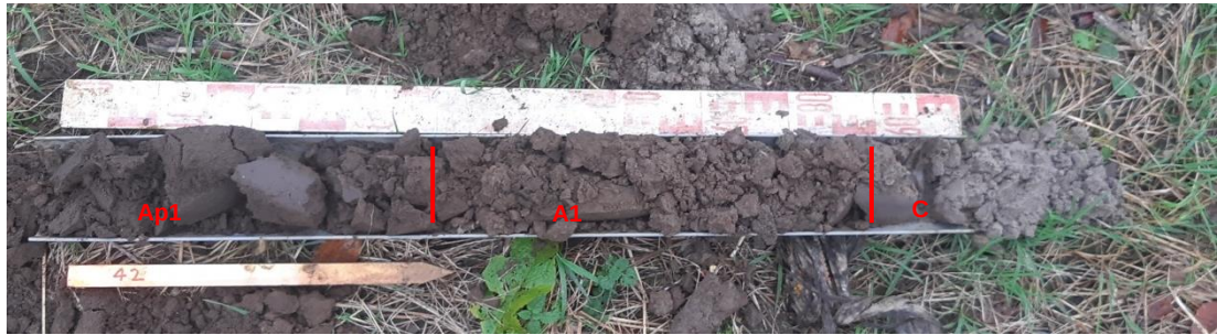
Afbeelding 14: Boring 42 met van links naar rechts de bouwvoor (Ap1), de eerdlaag (A1) en het dekzand (C).
