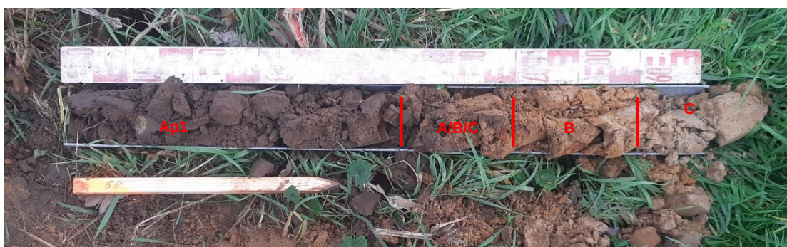
Afbeelding 17: Boring 68 met van links naar rechts de bouwvoor (Ap1), de menglaag (A/B/C), de zwak ontwikkelde B-horizont (B) en het dekzand (C).
