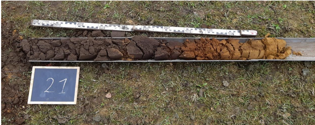
Afbeelding 23: Foto van het boorprofiel van boring 21 met v.l.n.r. de bruine humeuze bouwvoor, de bruingeel gevlekte ophooglaag, van 70 cm-mv tot 85 cm-mv de podzol B (veldpodzol) en vanaf 85 cm-mv geel fijn dekzand.
