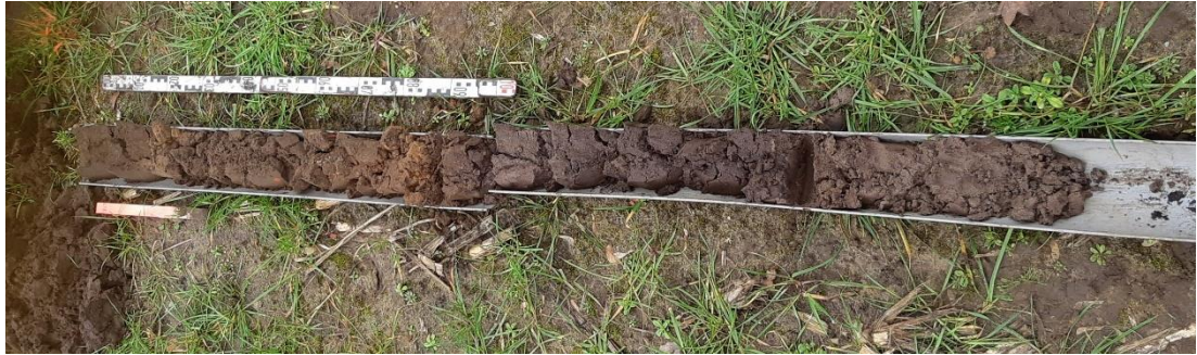
Afbeelding 21: Foto van het boorprofiel van boring 10 met v.l.n.r. de bruine humeuze bouwvoor, de grijs/bruin/geel gevlekte ophooglaag met baksteenpuin, kalkmortel en houtskool, vanaf 90 tot 150 cm-mv het bruine plaggendeek of grondspoor (?) en vanaf 150 cm-mv grijs fijn dekzand.
