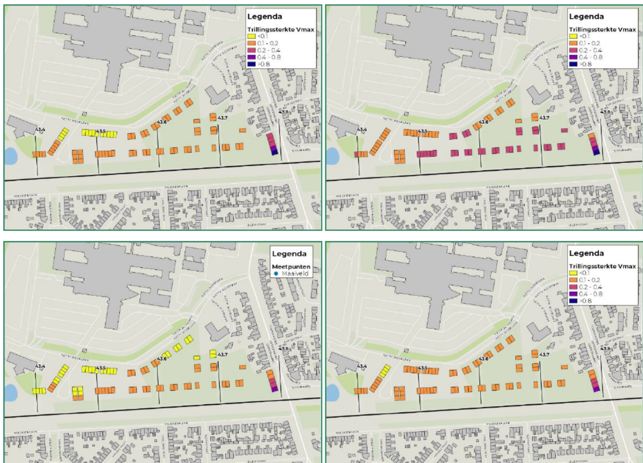
Figuur 7 Trillingssterkte V_{\max} , links ondergrens, rechts de bovengrens, boven overdag, onder in de nacht
