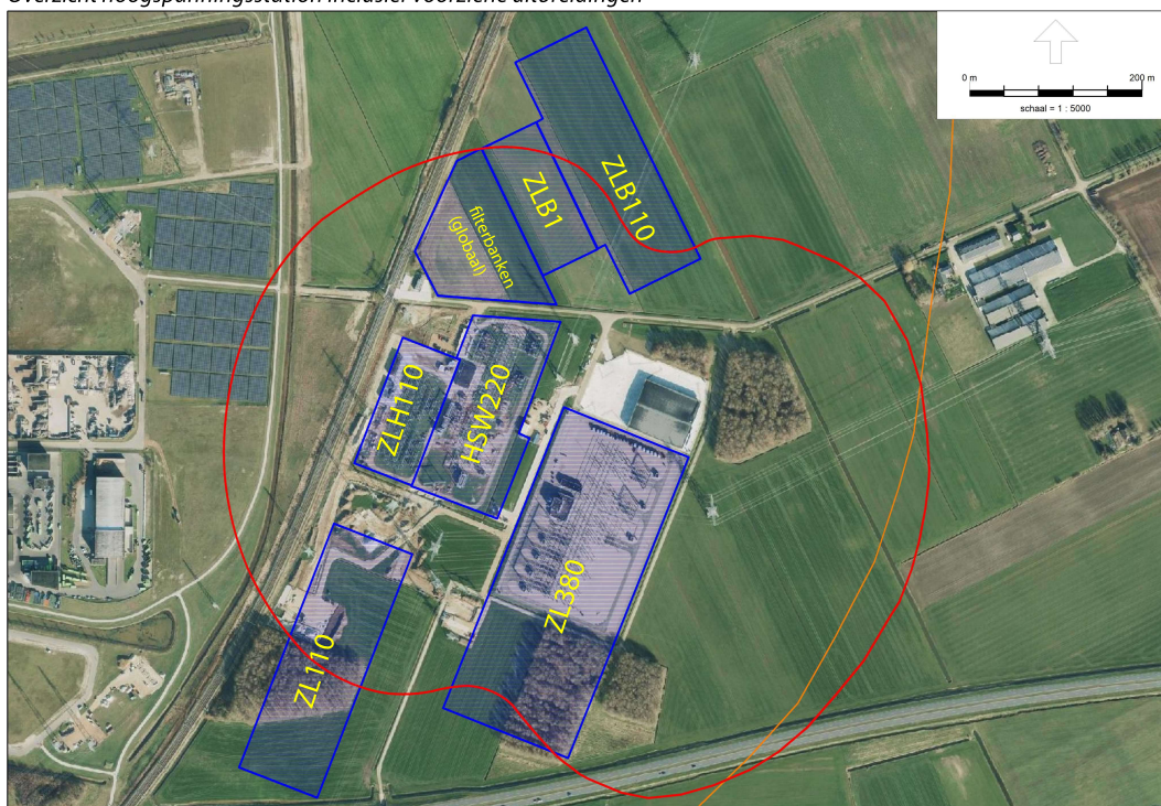
f2.4 Overzicht hoogspanningsstation inclusief voorziene uitbreidingen
