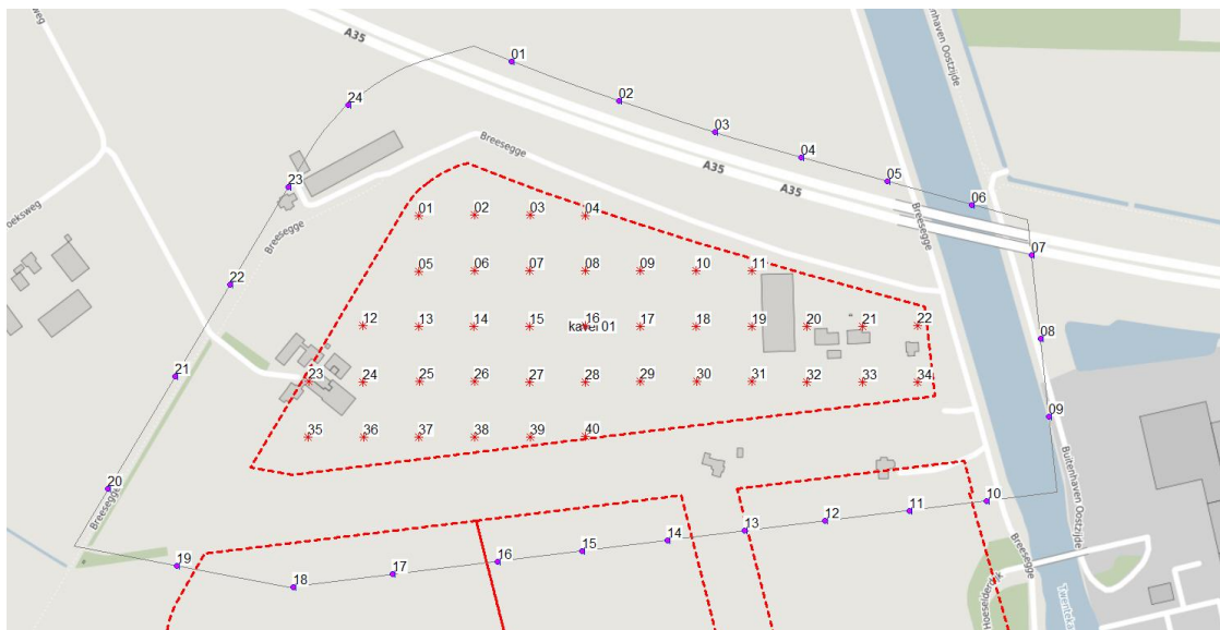
figuur 4: weergave van het rekenmodel voor het bepalen van de maximale invulling van de geuremissie voor een kavel. De emissie is zodanig dat op 100 meter afstand de beschikbare geurruimte ( 0,15 \text{ OU}_E/\text{m}^3 ) geheel wordt gevuld.
