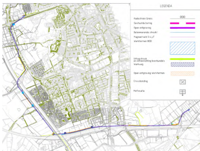
Figuur 1.3.1 | Route kabelcircuits (deels gestuurde boringen en deels open ontgraving)
