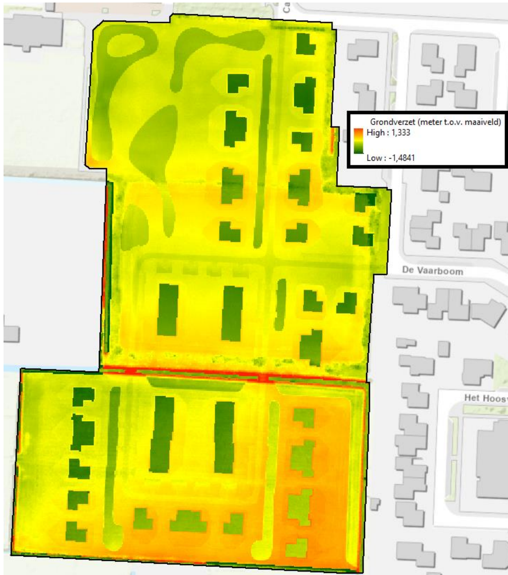
Figuur 6-2: Grondverzet (in meters t.o.v. maaiveld). Positieve getallen betekenen een ophoging van grond ten opzichte van de huidige situatie, negatieve getallen betekenen een afgraving ten opzichte van de huidige situatie
