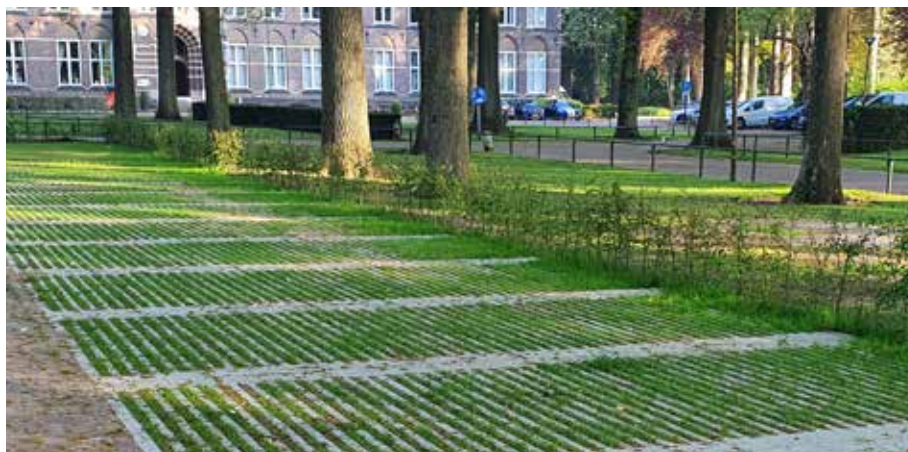
Referentiebeeld grasbetonplaten op parkeerplaatsen (Soliddrain Connect)
